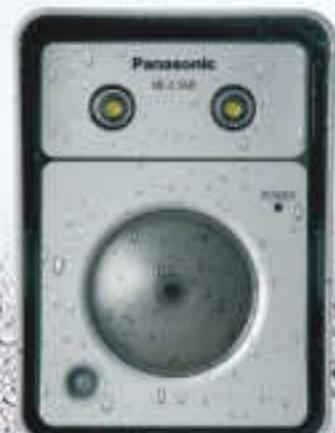
Kamery BL-C160 a BL-C140 so zvýšenou odolnosťou proti striekajúcej vode (podľa špecifikácie IPX4) sú pripravené aj pre umiestnenie vo vonkajšom prostredí. Dokážu detektovať pohyb pred objektívom a model BL-C160 so zabudovaným LED osvetlením má integrovaný aj snímač prítomnosti osôb.
